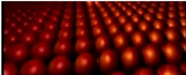
Sur cette représentation, on observe des atomes de cuivre obtenu au microscope électronique où les atomes apparaissent sphériques .
