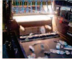
Deux broyages successifs permettent de transformer les bouteilles en paillettes de taille 8 mm.
