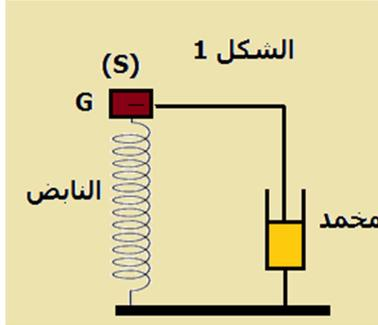
نمذج معايق السيارة بمتذبذب ميكانيكي تردد الخاص  $f_0$  له دور الرنان ، عند مرورها من تموجات أو حداث متتالية والتي تلعب دور المثير فإن السيارة ستخضع إلى دفعات دورية أي لها تردد وهو تردد المثير في حالة هذا التردد يساوي تردد الرنان  $f_0$  ستكون عندنا ظاهرة الرنين وبالتالي ستتلف السيارة
