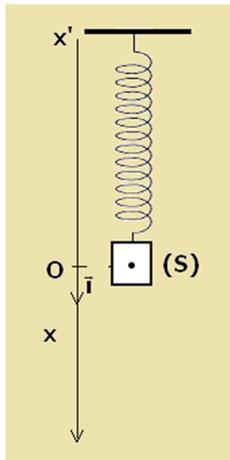
وصلابته  $k = 40\text{N/m}$  ، ومن جسم صلب (S) كتلته  $m = 500\text{g}$  . أنظر الشكل
